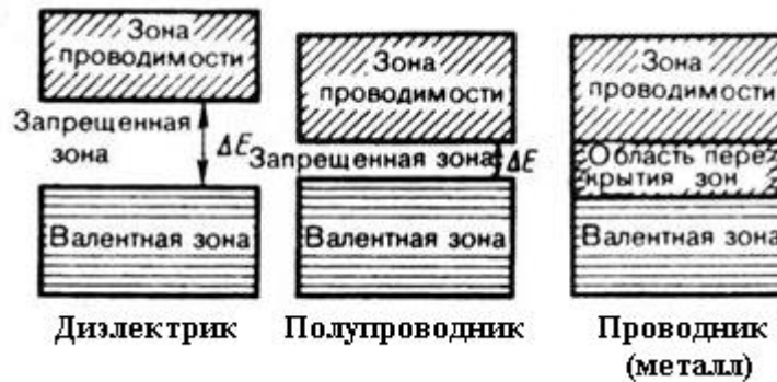
Рис. 1. Зонная структура диэлектриков, полупроводников и проводников.
