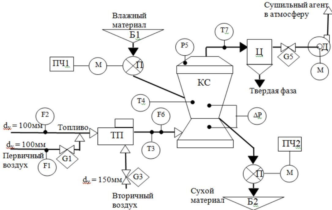
Состав технологической схемы: КС – сушилка кипящего слоя; Б1 и Б2 – бункеры влажного и сухого материалов соответственно; ТП – топка; ПЧ1 и ПЧ2 – частотные преобразователи; П – питатель; Ц – циклон; Д – дымосос.
