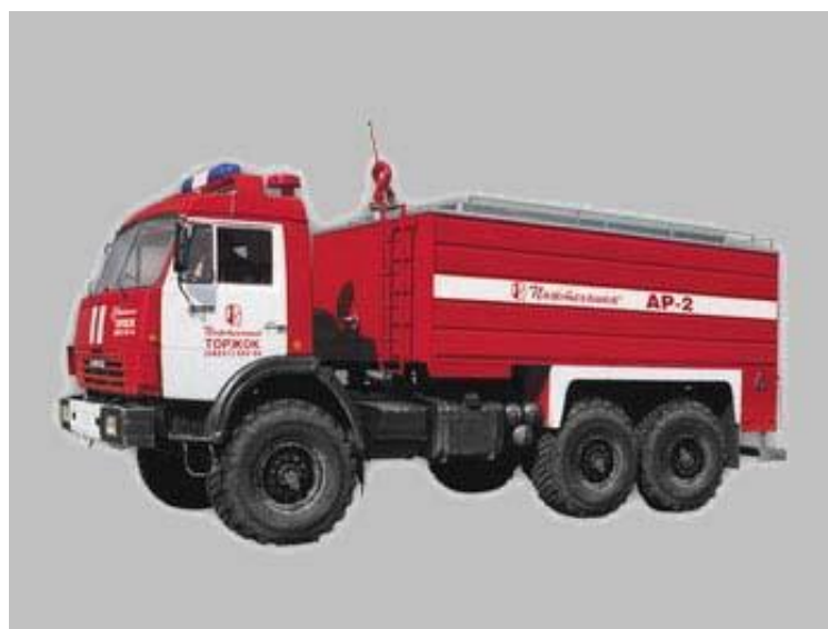
Рис. 6.7. Внешний вид пожарного рукавного автомобиля АР-2
