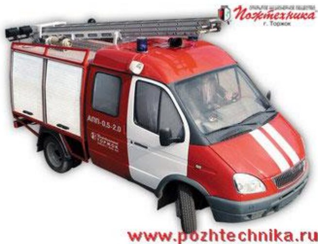
Рис.6.1. Внешний вид автомобиля первой помощи АПП-0,5-2
