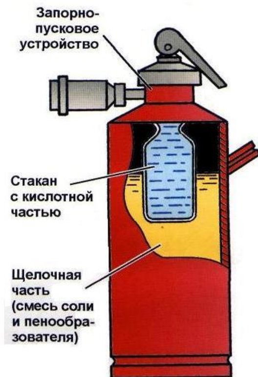
Рис. 7.8. Внутреннее строение химических пенных огнетушителей
