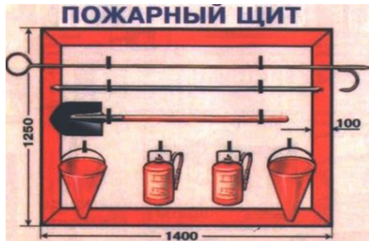
Рис. 7.21. Внешний вид пожарного щита
