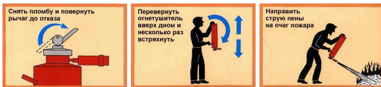
Рис. 7.9. Приведение в действие химического пенного огнетушителя
