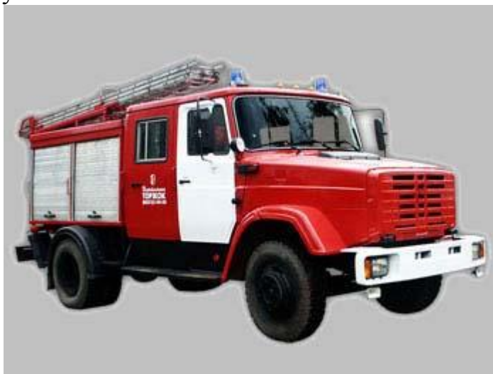
Рис. 6.3. Внешний вид пожарной автоцистерны АЦ 2,5-40 среднего типа
