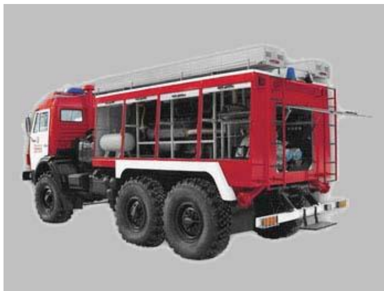
Рис. 6.6. Внешний вид пожарной насосной станции ПНС-110
