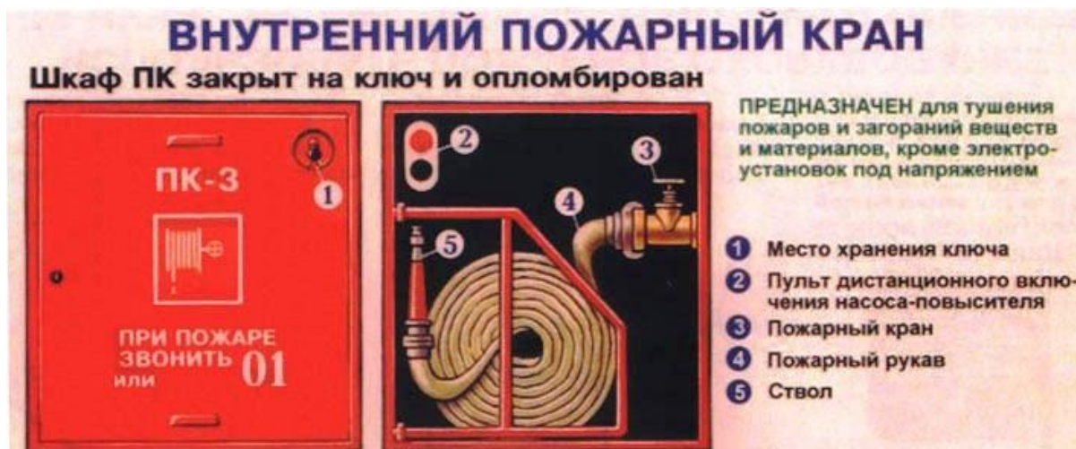
Рис. 7.18. Внешний вид внутреннего пожарного крана
