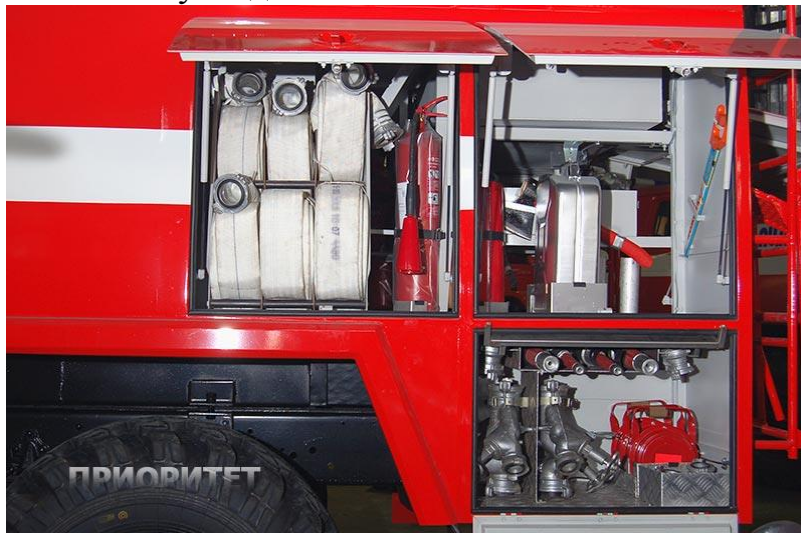
Рис. 6.18. Пожарно-техническое вооружение, размещенное в пожарном автомобиле
