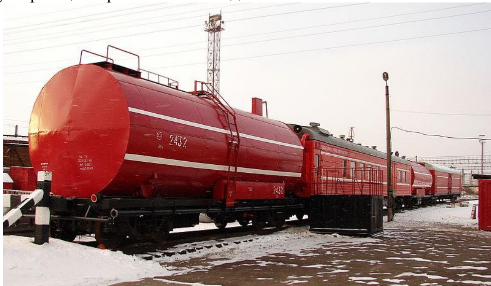
Рис. 6.14. Внешний вид пожарного поезда
