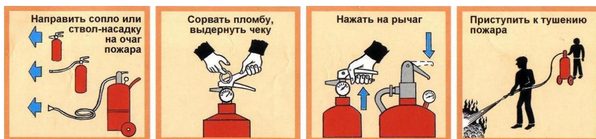
Рис. 7.17. Приведение в действие закачного огнетушителя
