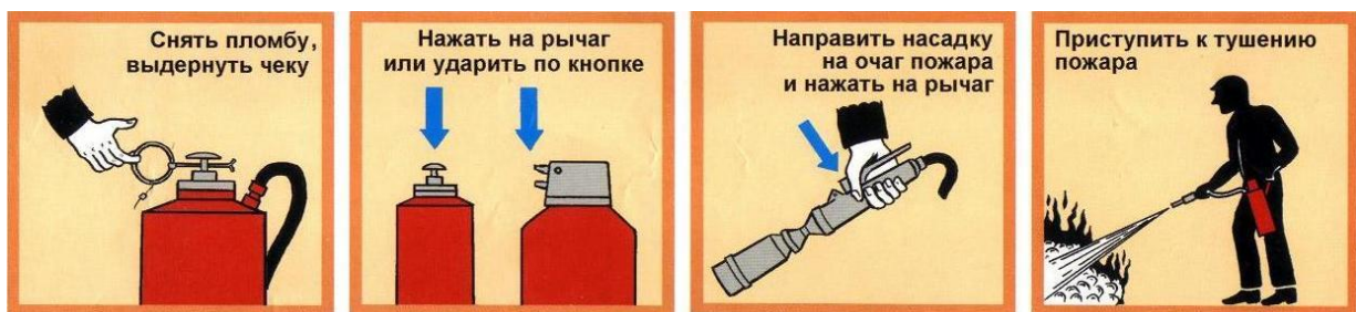
Рис.7.11. Приведение в действие воздушно-пенного огнетушителя
