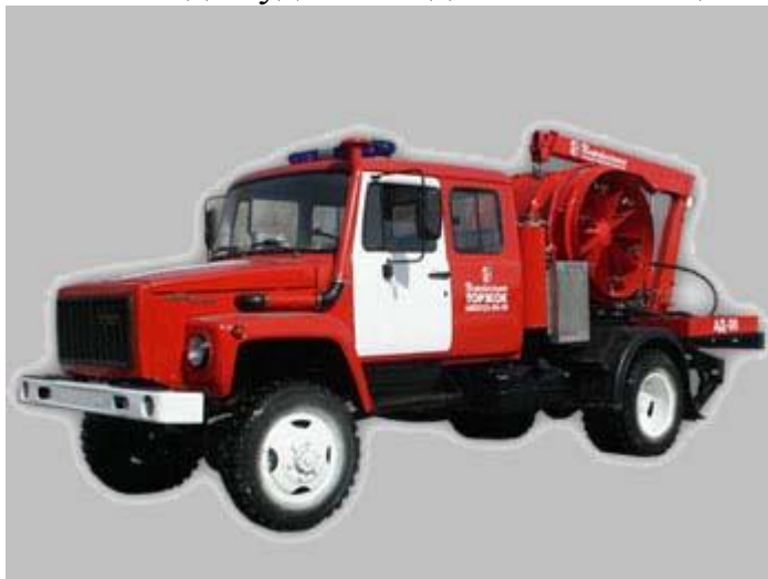
Рис. 6.12. Внешний вид автомобиля пожарного дымоудаления АД
