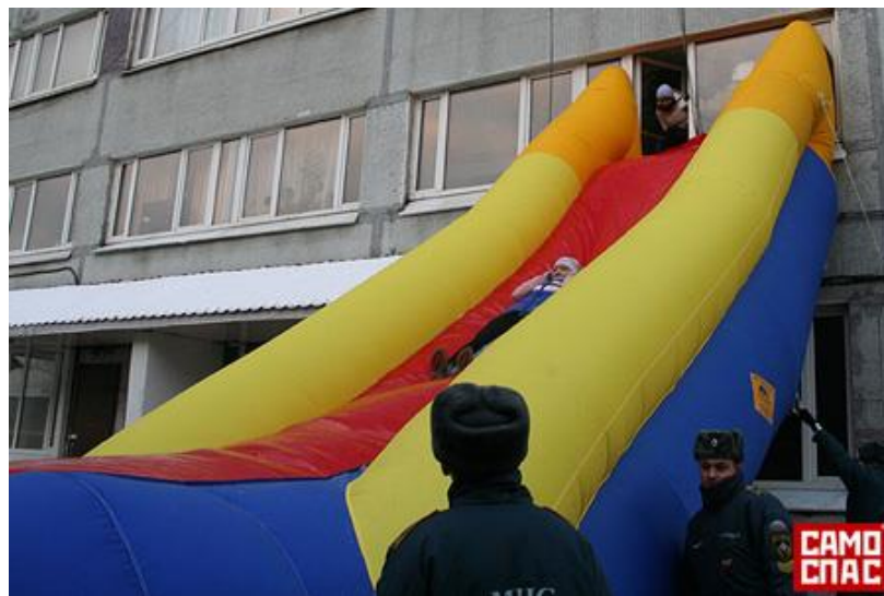
Рис. 9.29. Надувное устройство эвакуации Тобогган УЭТ-05.
