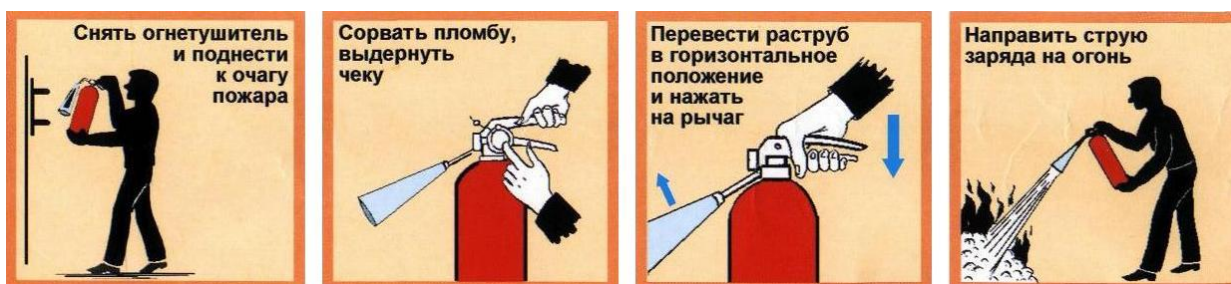
Рис. 7.4. Приведение в действие ручного углекислотного огнетушителя
