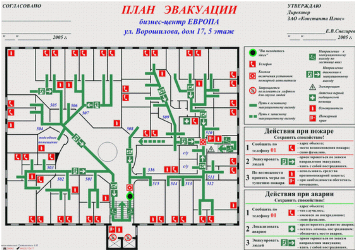
Рис. 10.1. Образец графической части Плана эвакуации
