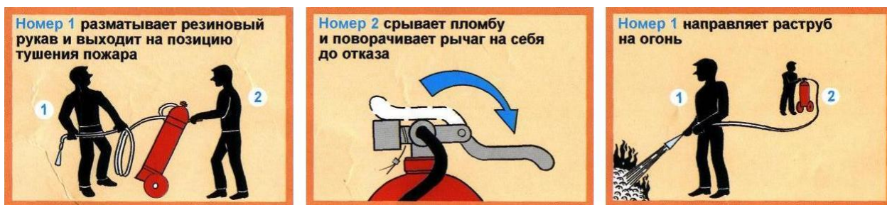
Рис. 7.5. Приведение в действие передвижного углекислотного огнетушителя
