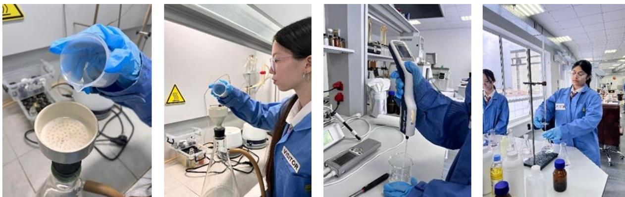
Рисунок 1,2,3,4 - Определение примесей, жесткости, плотности и степени загрязненности воды
