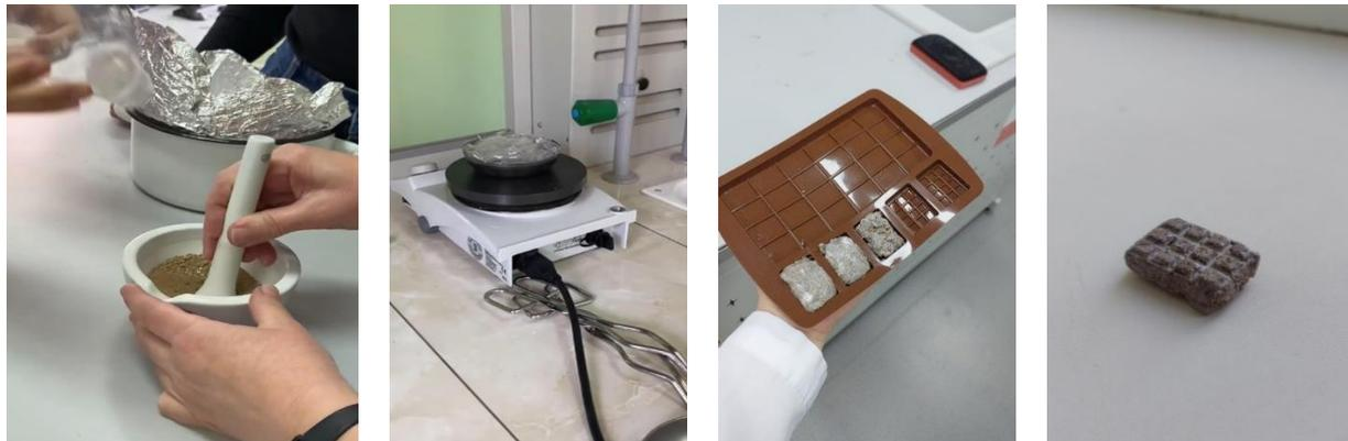
Рисунок 1,2,3,4 - Процесс изготовления образца
