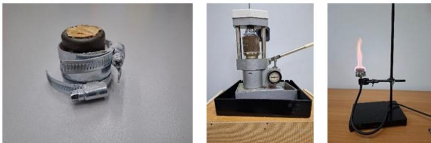
Рисунок 2 - Прессформа, гидравлический пресс, работа с горелкой с дутьем
