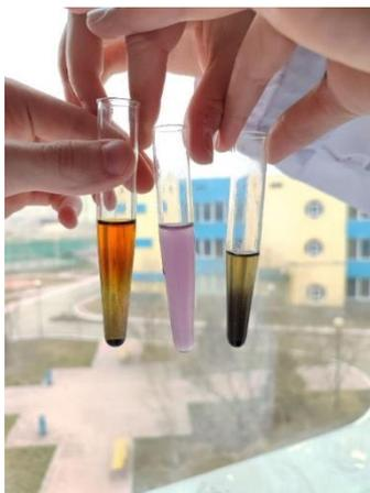
Рисунок 4 - Определения содержания хлора
