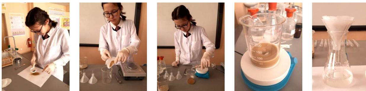
Рис 3. Процесс подготовки водной вытяжки образцов почв
