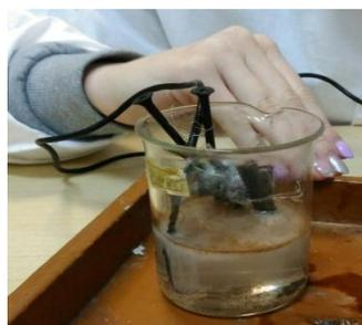
Фото 2. Установка для получения ферратов. В качестве электродов служил металлический лом
