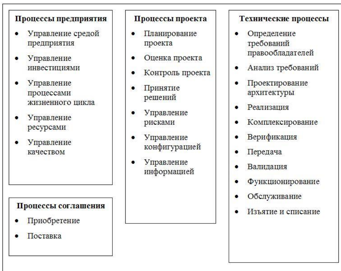
Рисунок 1. Процессы жизненного цикла системы [7, Рисунок D.8]
