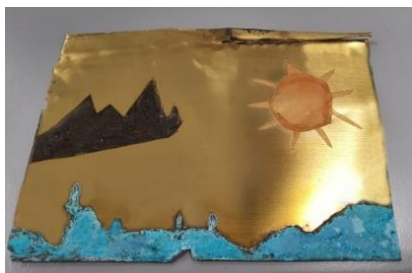
Рис. 3. Чёрное окрашивание поверхности сплава (горы)
