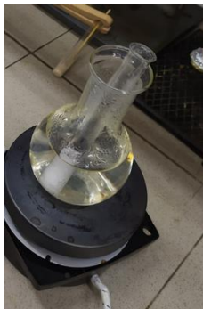
Рис.2. Нагревание пробирки с кристаллогидратом тиосульфата натрия на водяной бане
