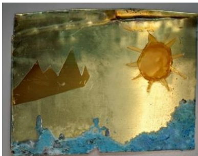
Рис. 2. Оранжевое окрашивание поверхности сплава (солнце)
