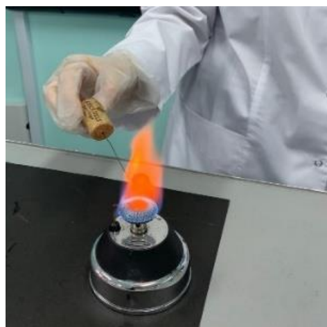
Рисунок 1. Процесс определения кислотности методом титрования и ионов кальция по цвету пламени
