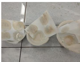
Рис.2 Техника очистки листов бумаги погружением в раствор.
