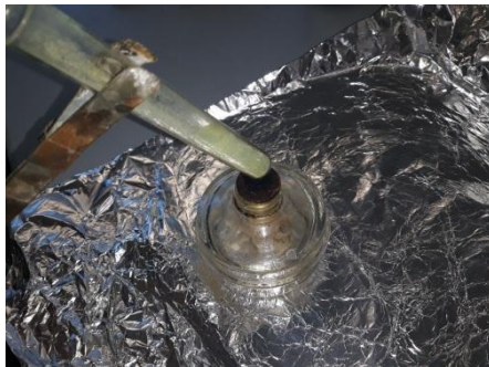
Рис.2 Варка стекломассы оказалась для нас самой сложной операцией
