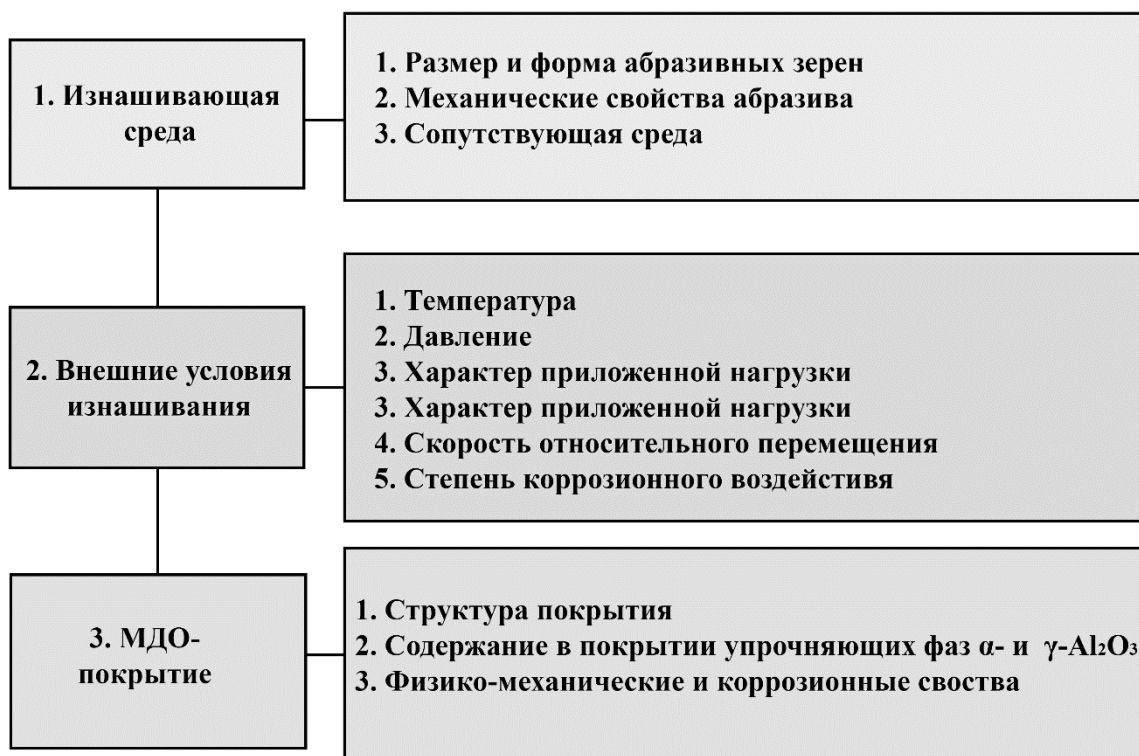
Рисунок 1.14 — Структурная схема модели изнашивания керамических МДО-покрытий [119]
