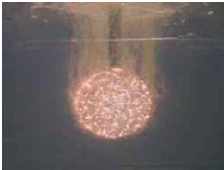
Рисунок 3.2 — Искровые разряды на аноде, процесс МДО
