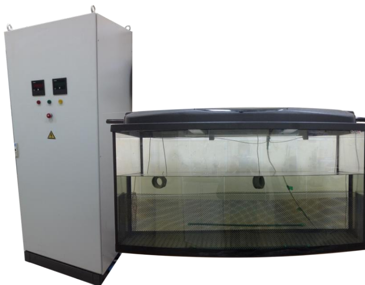
Рисунок 2.1 — Общий вид установки для МДО «ИПТ-1000»
