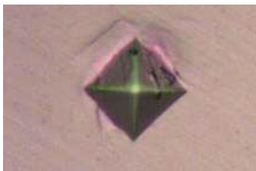
Рисунок 2.6 — След отпечатка пирамидки по методу Виккерса
