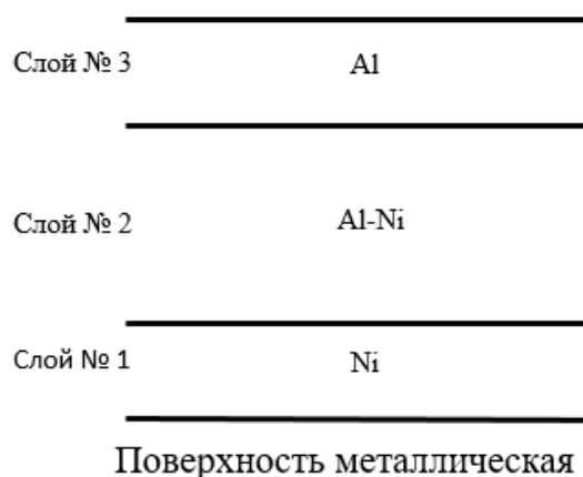
Рисунок 4.8 — Схема формирования трехслойного покрытия методом ХГДН
