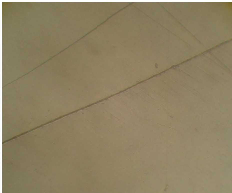
Рисунок 3.30 – Микрофотография глянцевого эпоксидно-полиэфирного покрытия на поверхности стали, увеличение 1000 x
