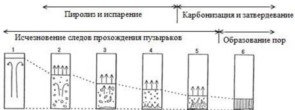
Рисунок 3 – Схема процесса формирования игольчатого кокса
