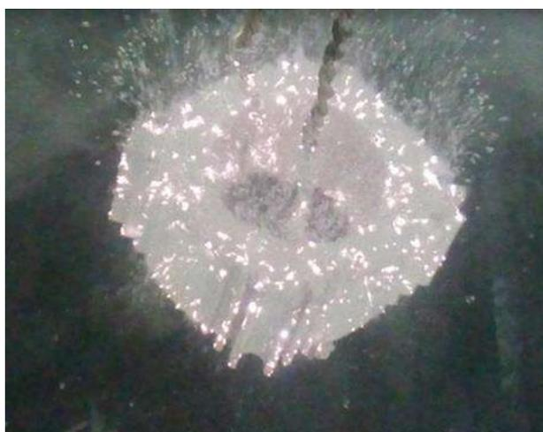
Рисунок 3.3 – Микроплазменные разряды на поверхности алюминиевой детали (МДО-процесс)
