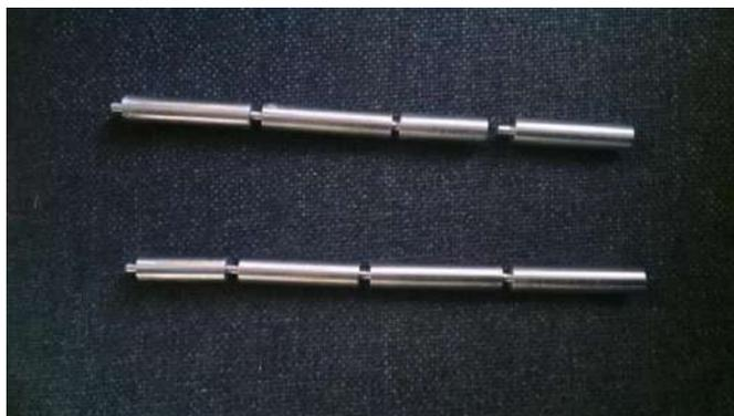
Рисунок 2.10 – Внешний вид образцов для проведения коррозионных испытаний в потоке свинцового теплоносителя
