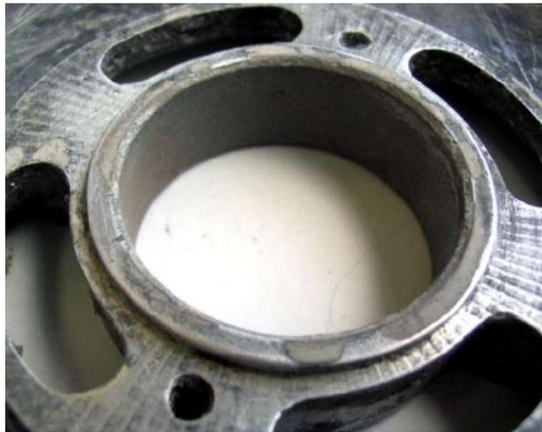
Рисунок 3.67 – Подшипниковый щит после восстановления, общий вид
