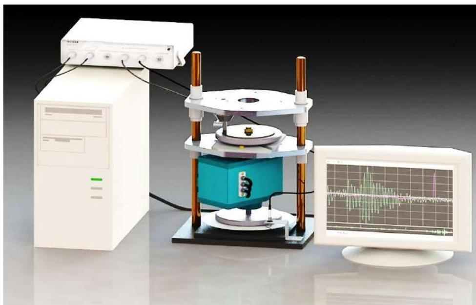
Рисунок 2.15 – Общий вид системы регистрации АЭ
