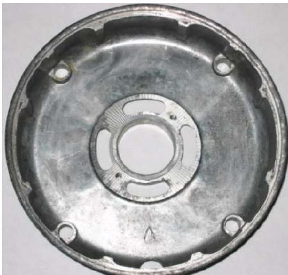
Рисунок 3.66 – Подшипниковый щит, общий вид
