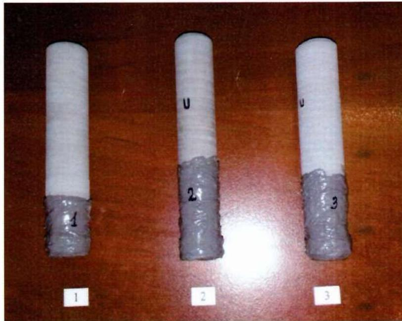
Рис. 1 - Фото образцов с керамическим покрытием, полученном на режиме постоянного тока до испытаний на коррозионную стойкость в нейтральном соляном тумане
