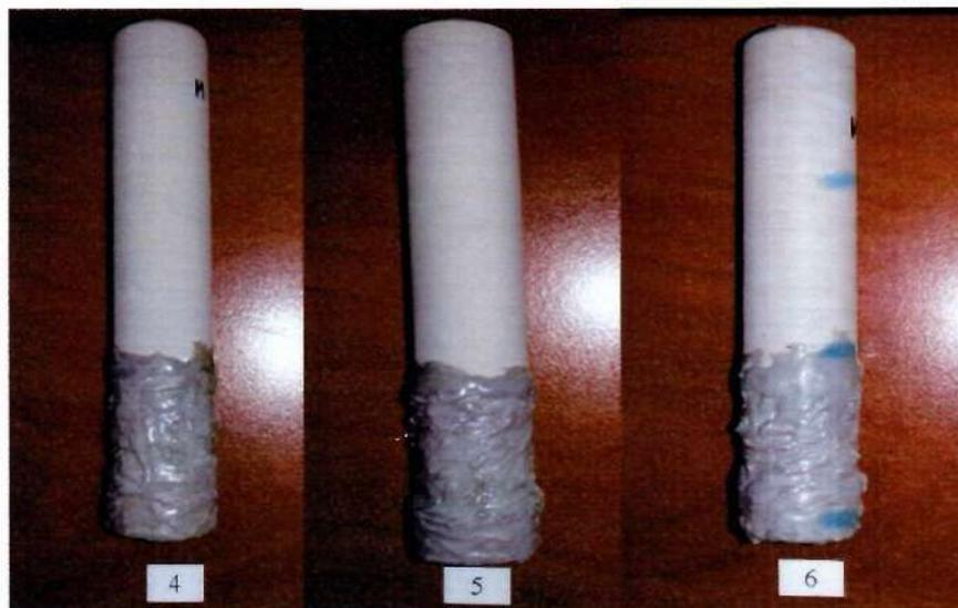
Рис. 4 – Фото образцов с керамическим покрытием, полученном на режиме импульсного тока после 1000 часов испытаний на коррозионную стойкость в нейтральном соляном тумане
