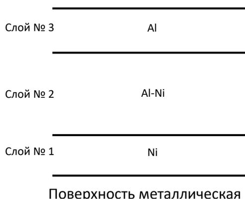
Рисунок 3.45 – Схема напыления функционально-градиентного покрытия методом ХГДН
