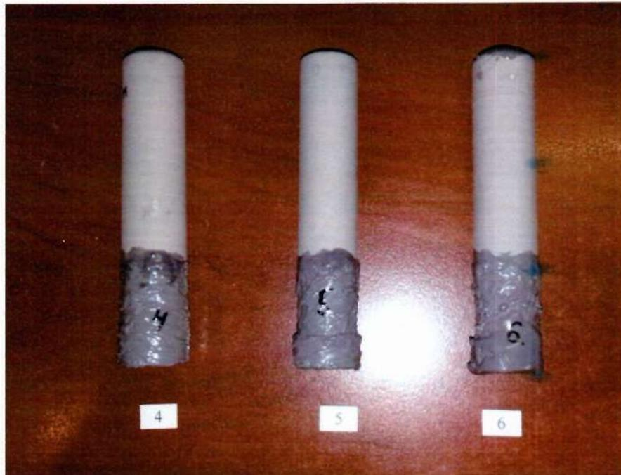
Рис. 3 – Фото образцов с керамическим покрытием, полученном на режиме импульсного тока до испытаний на коррозионную стойкость в нейтральном соляном тумане
