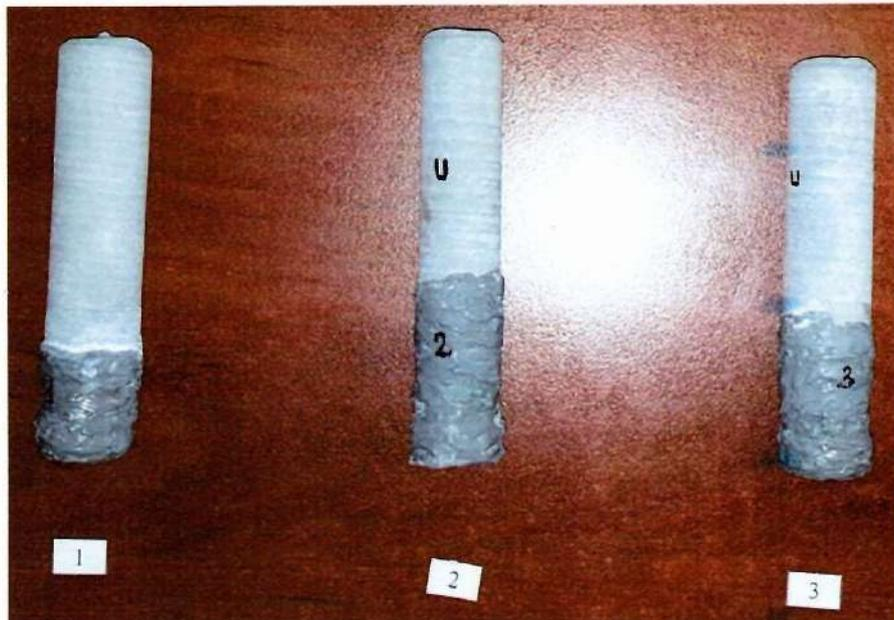
Рис. 2 – Фото образцов с керамическим покрытием, полученном на режиме постоянного тока после 1000 часов испытаний на коррозионную стойкость в нейтральном соляном тумане
