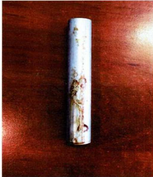
Рис. 5 – Фото образца №7 (без покрытия) после 1000 часов испытаний на коррозионную стойкость в нейтральном соляном тумане
