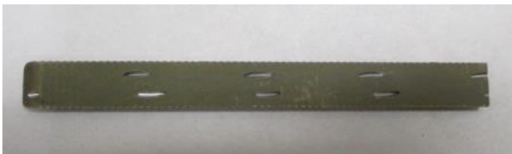
Рисунок 31 – Фрагмент заготовки стержня для контроля расположения каналов
