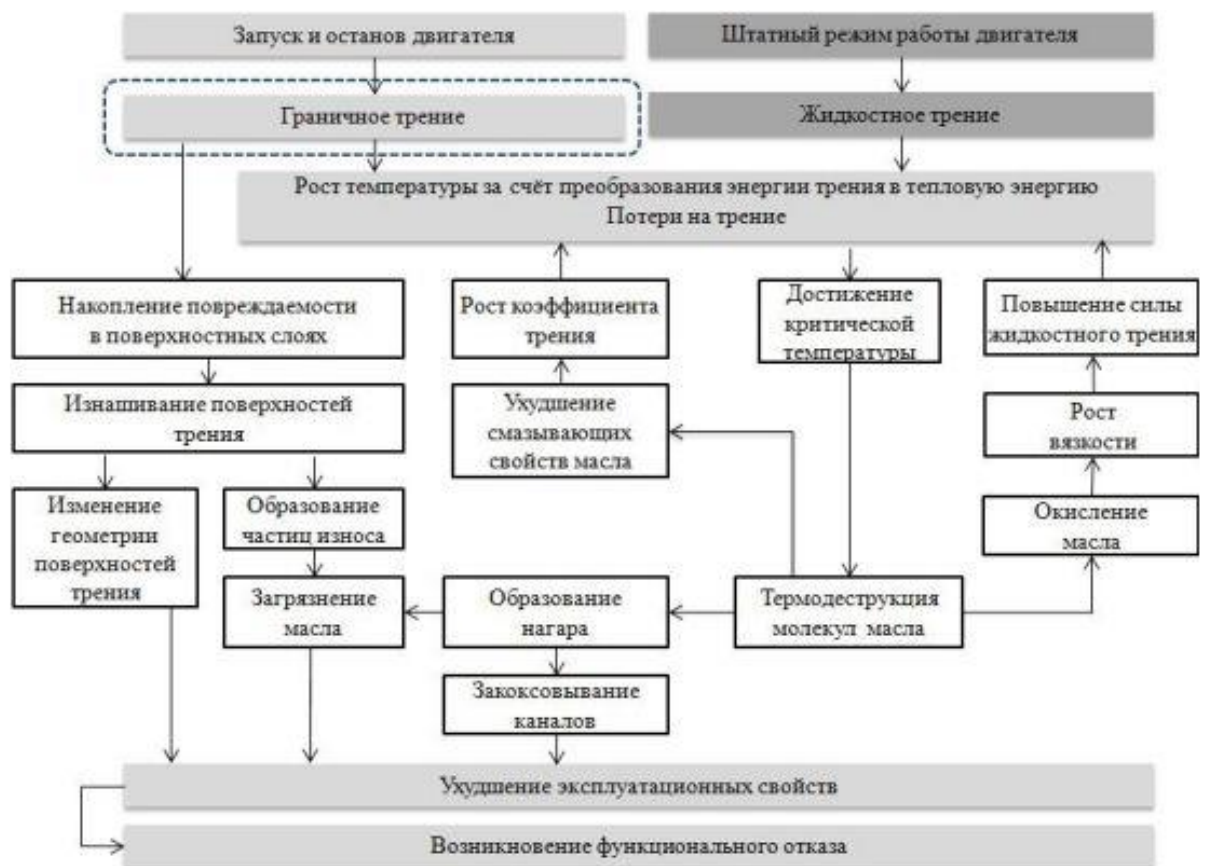
Рисунок 1 – Схема развития функционального отказа [15]
