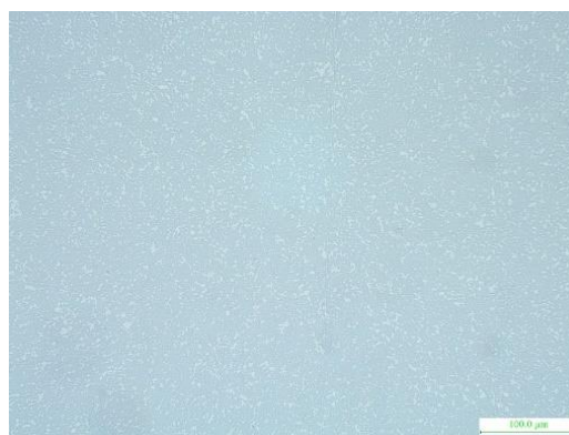
Рисунок 44 – Микроструктура контрольного образца твердого сплава BN20, увеличение 200 ×
