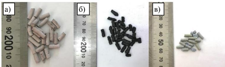
Рисунок 4 – Фотографии гранул катализатора 2-ой стадии гидропереработки гудрона: свежего (а), отработанного (б) и отработанного после термической обработки на воздухе (в)
