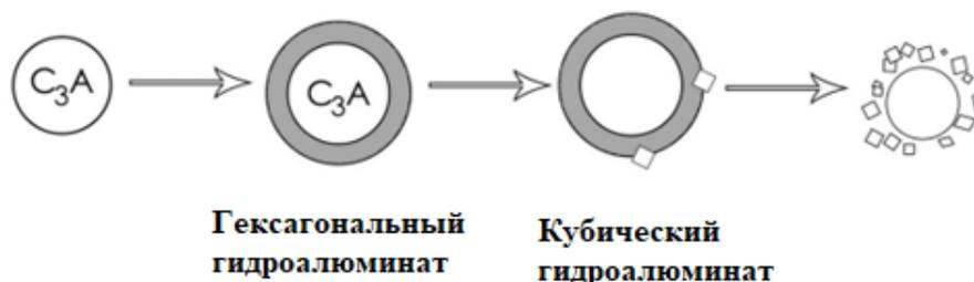
Рисунок 39 – Гидратация фазы  $C_3A$  в отсутствие гипса [91, 110]
