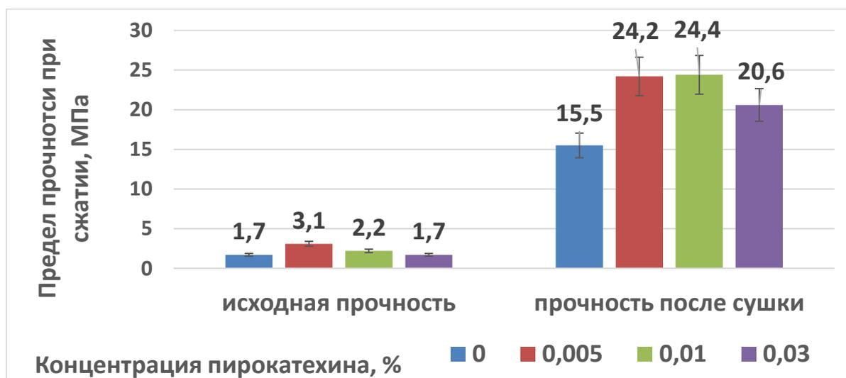
Рисунок 9 – Влияние добавки пирокатехина на предел прочности при сжатии образцов корундового бетона при 3,3 % масс. коллоидного связующего
