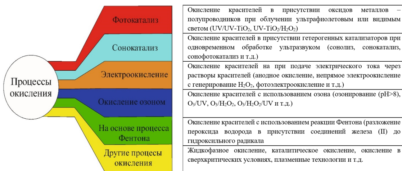
Рисунок 1.1 - Классификация процессов окисления, используемых в очистке воды.
