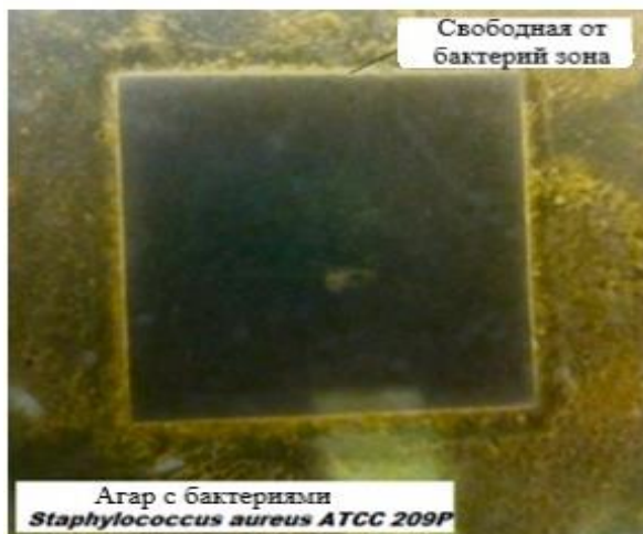
Рисунок 7 – Фотография стекла с покрытием, приготовленным из предварительно облученного УФ-излучением раствора, в чашке Петри с агаром, содержащим бактерии Staphylococcus aureus ATCC 209P
