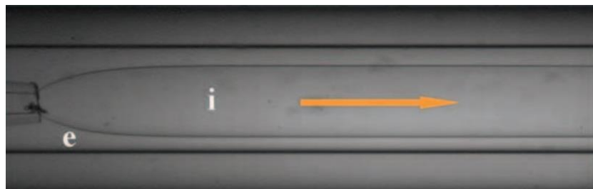
Рисунок 6 – Фотография потоков в микроканале i – подсолнечное масло, e – этанол
