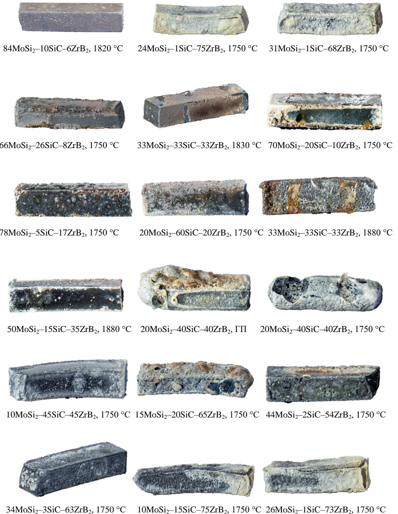
Рисунок 173 – Фотографии образцов после окисления в течение 120 ч
