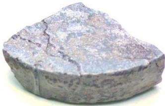
$\text{MoSi}_2\text{-Y}_3\text{Al}_5\text{O}_{12}$  (осажд.), 1450 °C
