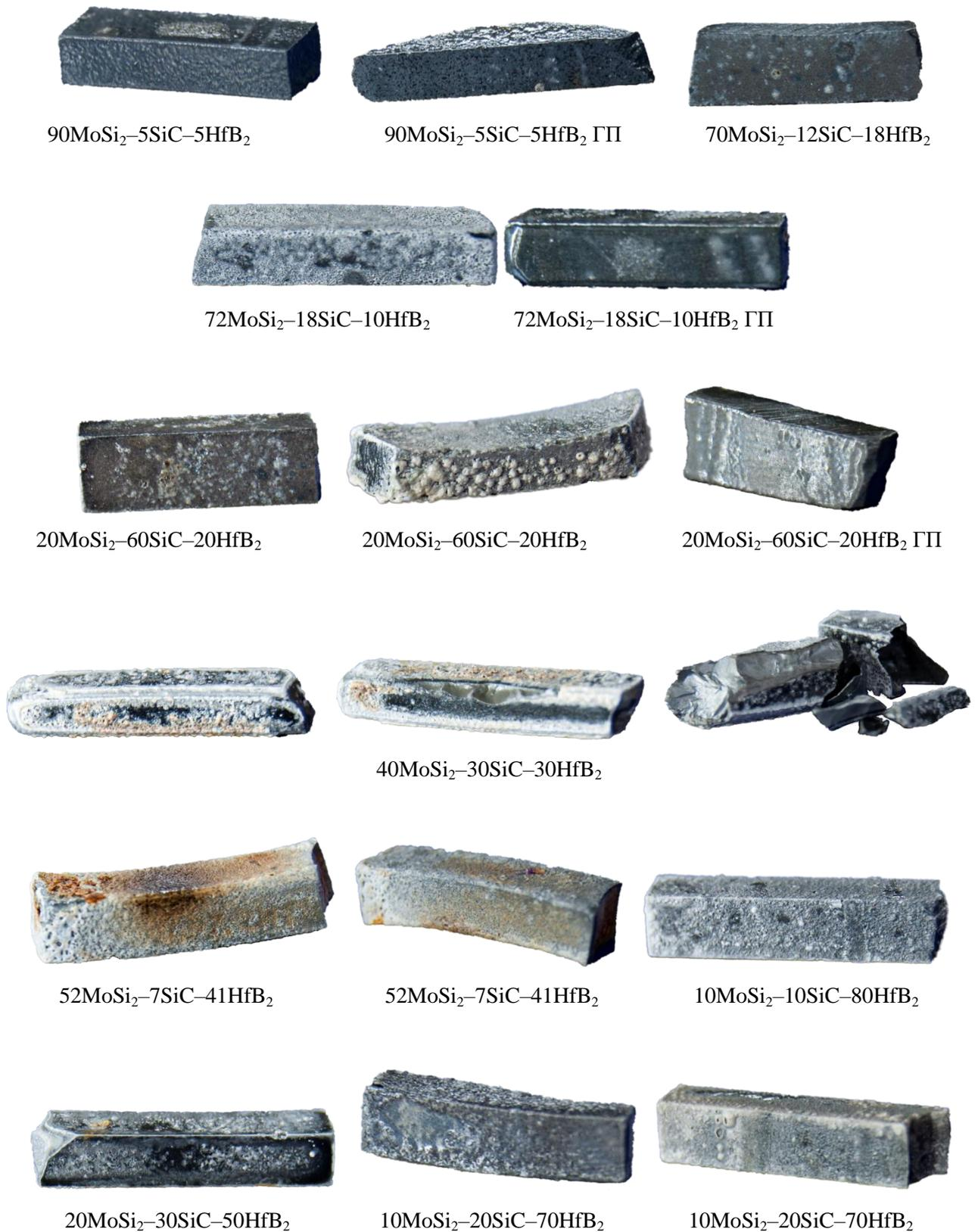
Рисунок 174 – Фотографии образцов после окисления в течение 120 ч
