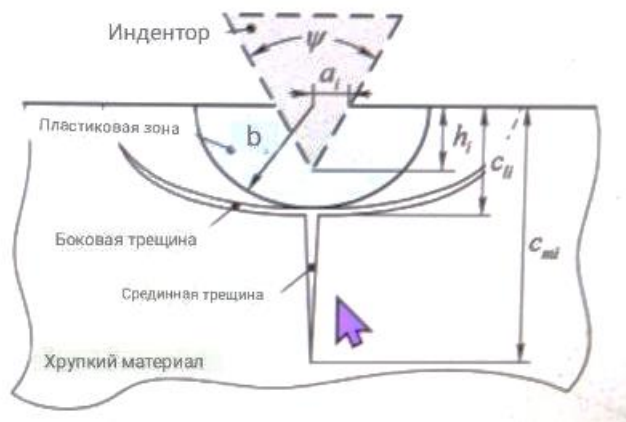
Рисунок 1.24 – Схема образования трещин при обработке жальным индентором
