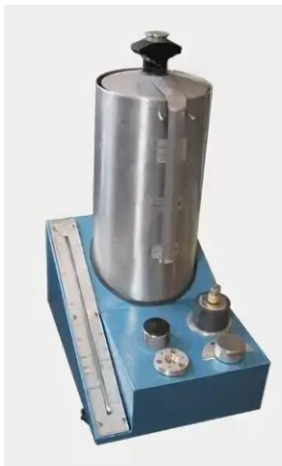
Рисунок А.3 – Прибор для определения газопроницаемости песков и влажных, сухих или отвержденных образцов формовочных и стержневых смесей согласно ГОСТ 23409.6–78.
