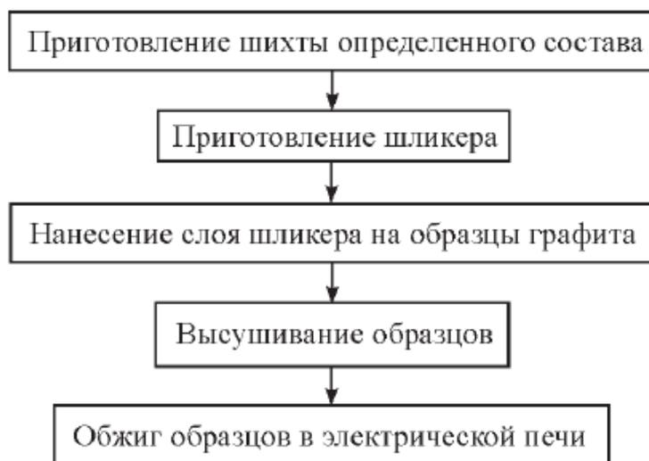
Рисунок 4 – Технологическая схема получения покрытий
