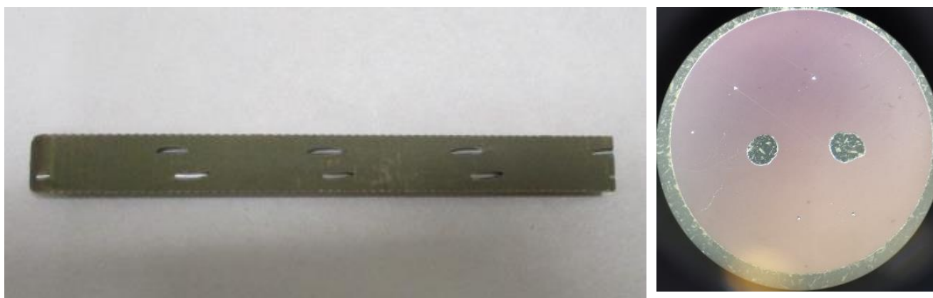
фрагмент заготовки стержня для контроля расположения каналов
