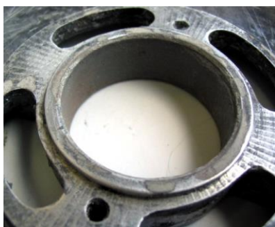
Рисунок 19 – Подшипниковый щит после восстановления, общий вид
