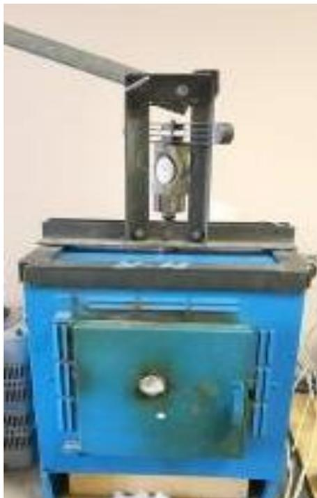
Рисунок 2.7 – Вакуумная печь с системой нагружения для изгибных испытаний
