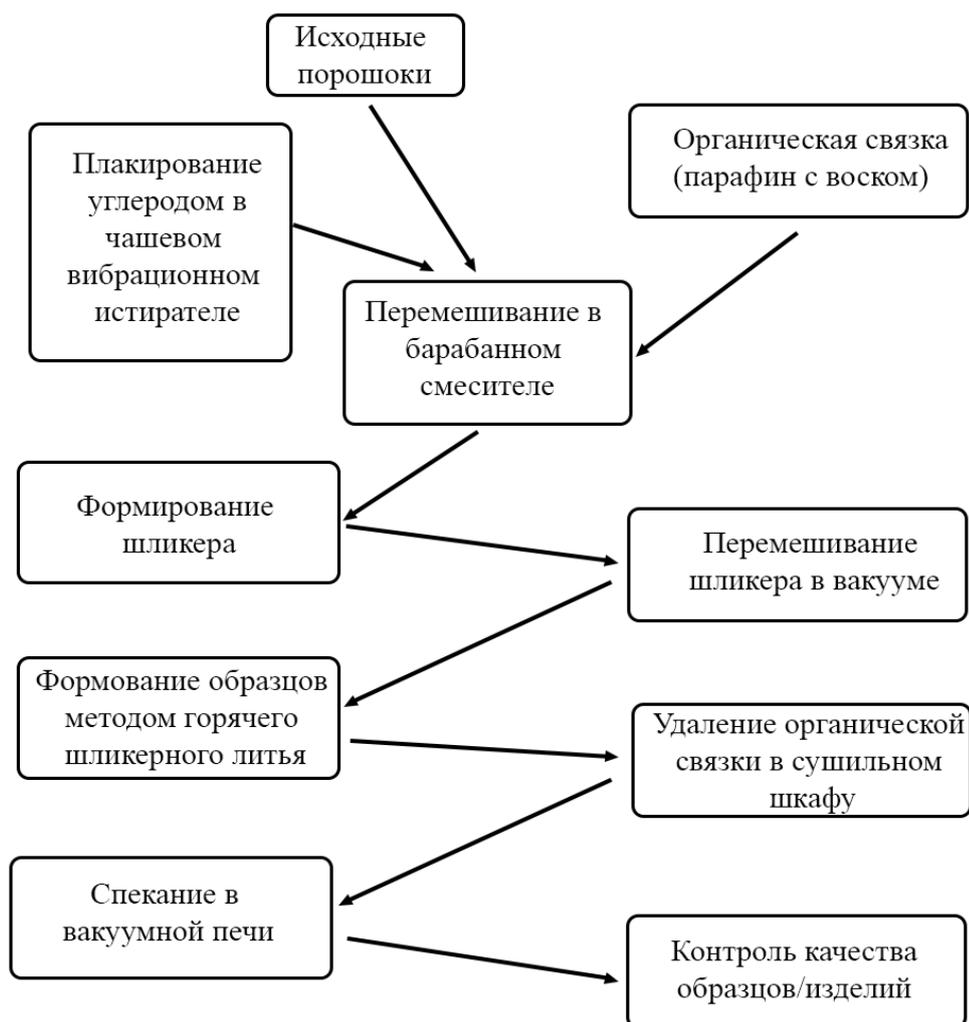
Рисунок 2.4 – Краткая схема получения керамики с использованием горячего шликерного литья
