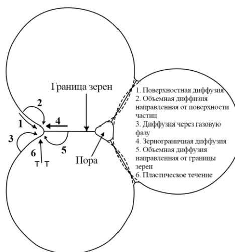
Рисунок 1.5 – Схематическое изображение шести различных механизмов, вносящих вклад в процесс спекания кристаллических частиц:
