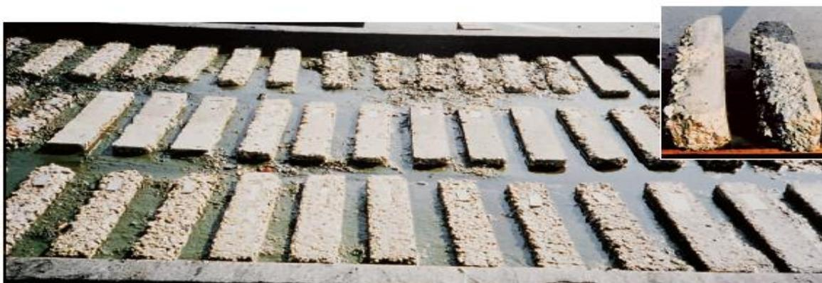
Рисунок 8- Бетонные балки, в течение 7 лет находившиеся во влажной, богатой сульфатами, почве (шт. Калифорния, США) [41]
