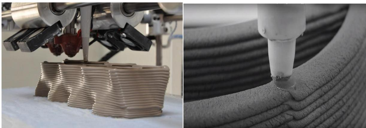
Рисунок 2 – Экструзионная 3D-печать трехмерного изделия из цементной композиции (справа в укрупненном масштабе показана экструзия растворной смеси из сопла печатающего устройства) [7]
